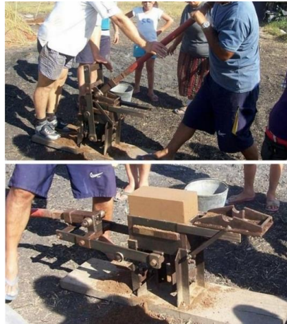
Figure 6. Elaboration of Blocks in Compressed Earth Source: Tierra al Sur Arquitectura Construcción
