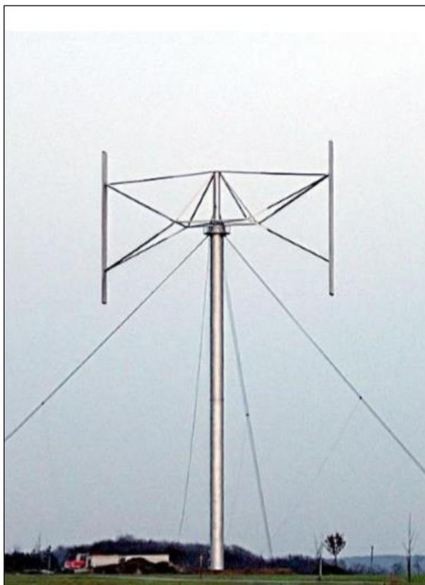
**Figura 18.** Aerogenerador Darrieus de alabe recto o Tipo H.
