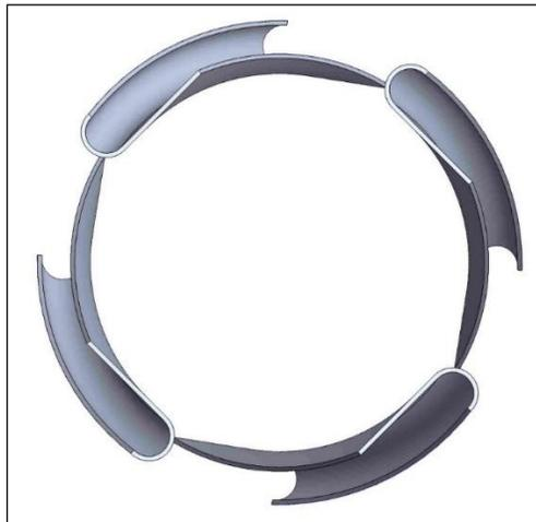
**Figura 38.** Vista de alzado de las palas del rotor eólico.
