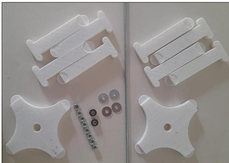
**Figura 44.** Elementos mecánicos usados para ensamblar el rotor.
