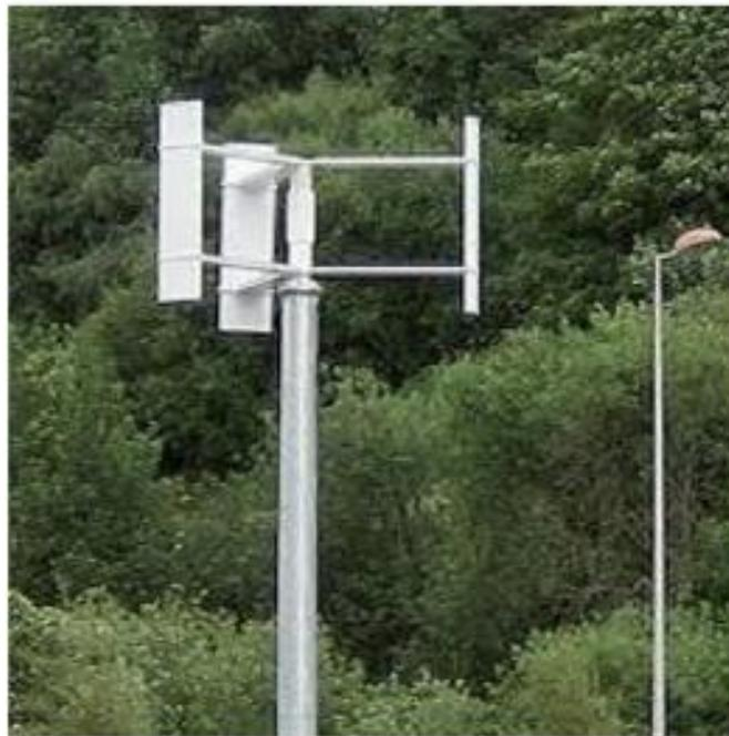
**Figura 16.** Turbina eólica de eje vertical de alabe recto.
