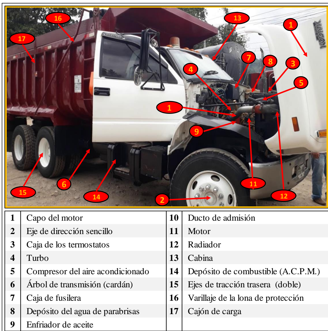
Figura 12. Partes de la volqueta.
