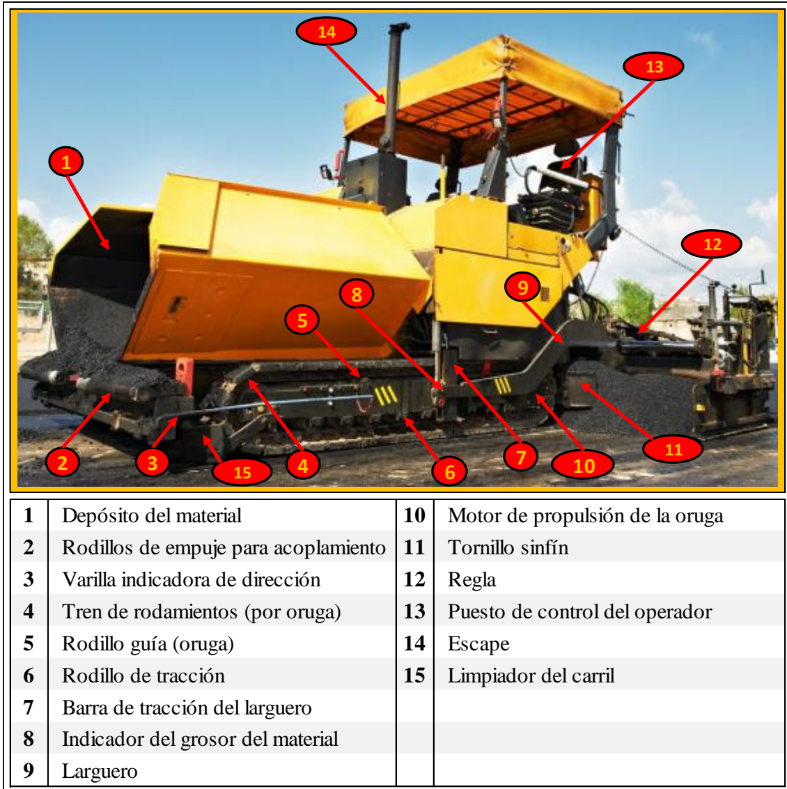
Figura 11. Partes de la terminadora de asfalto.
