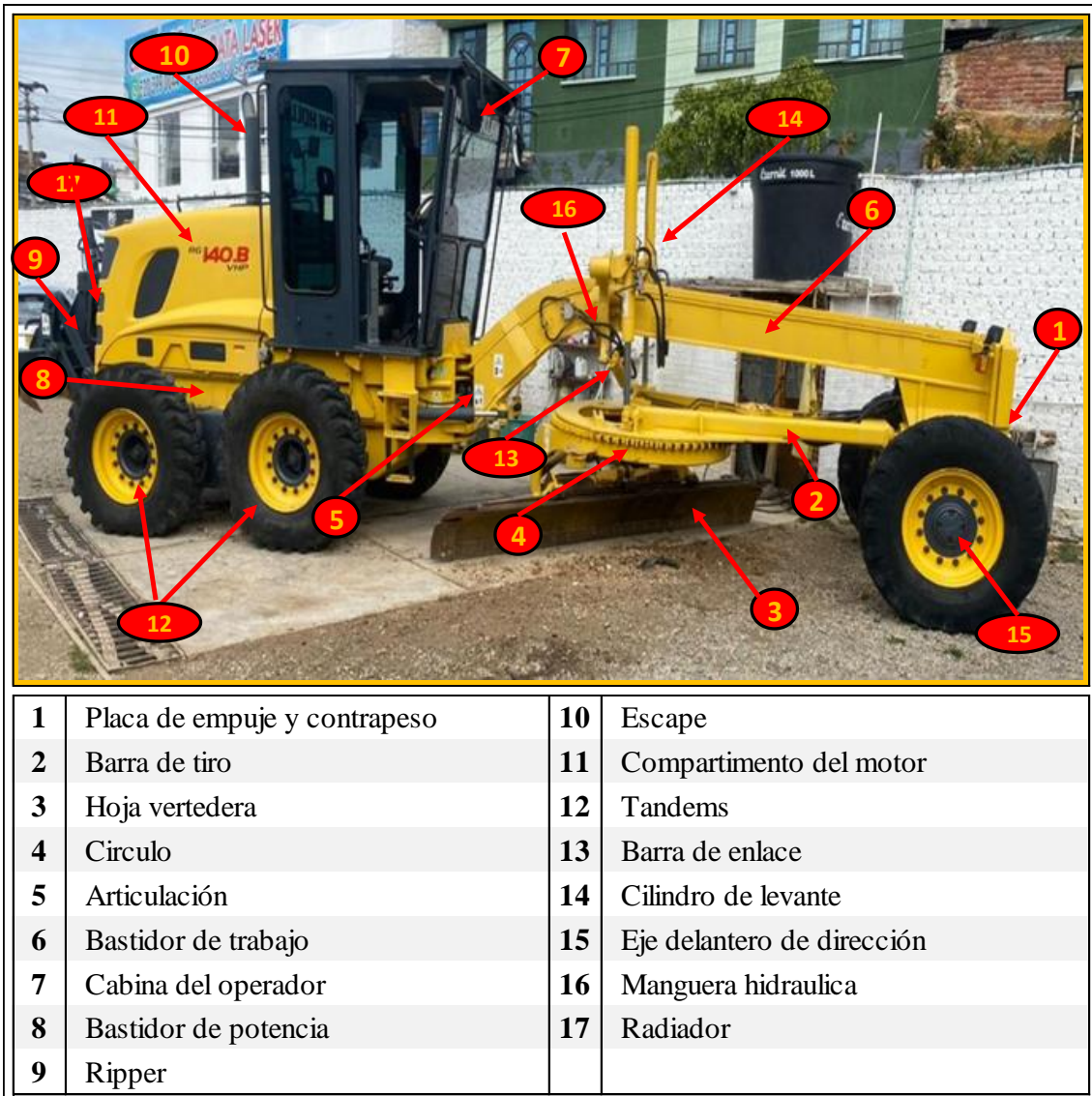
Figura 9. Partes de la motoniveladora.
