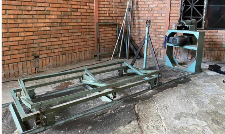
**Figura 8.** Perforadora de bloque de espuma cilíndrico
