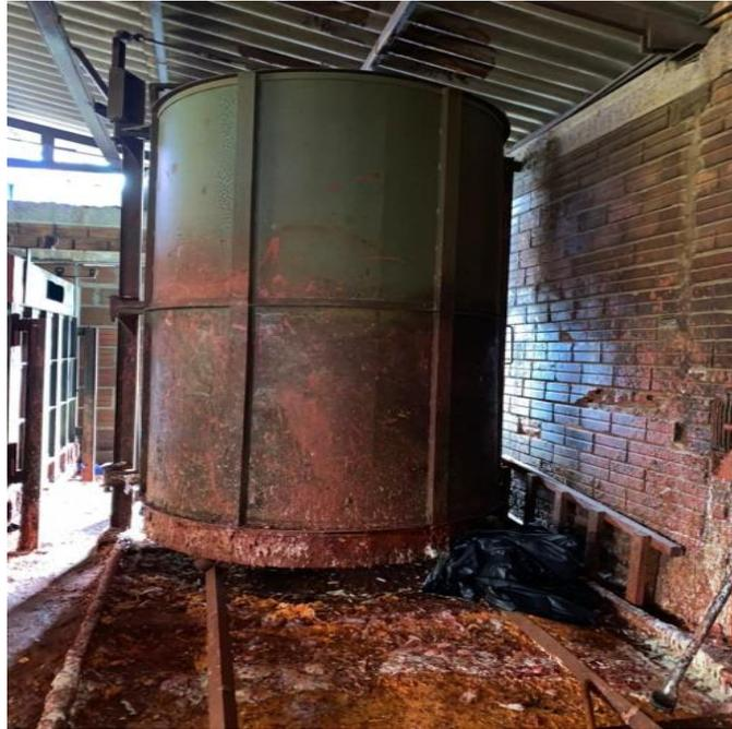
**Figura 4.** Molde cilíndrico de producción de espuma
