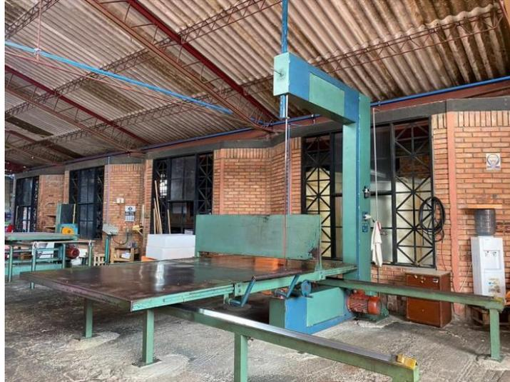
**Figura 6.** Cortadora vertical de espuma
