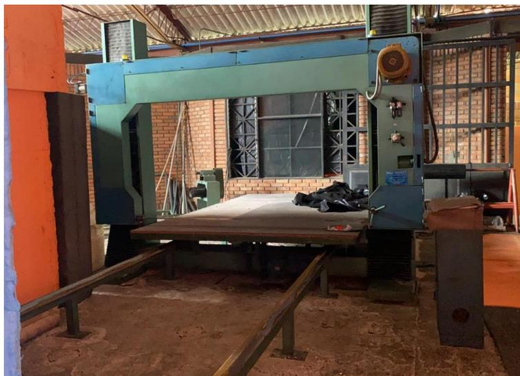
**Figura 5.** Cortadora horizontal de espuma
