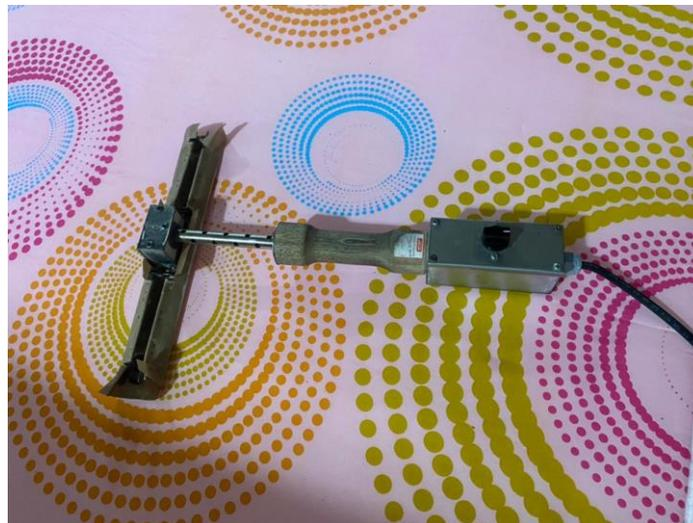
**Figura 11.** Plancha de termo sellado
