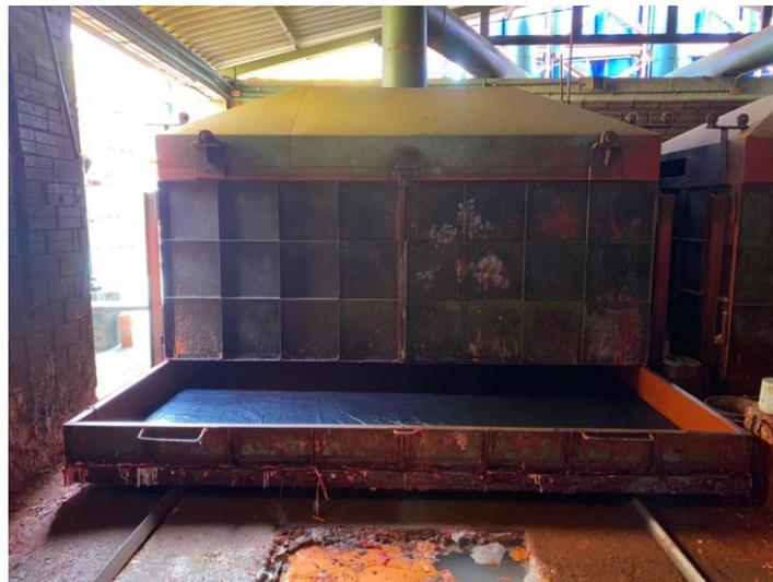
**Figura 3.** Molde rectangular de producción de espuma
