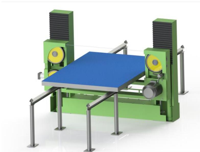
**Figura 32.** Diseño cortadora horizontal
