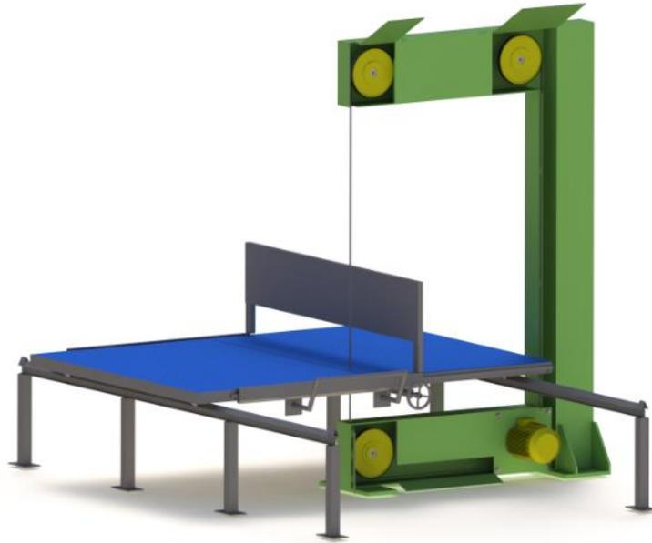
**Figura 30.** Diseño de la cortadora vertical
