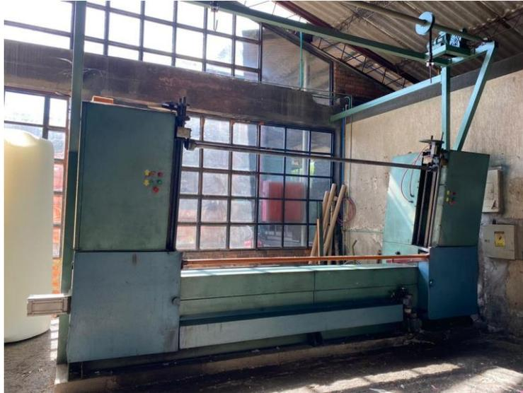
**Figura 9.** Rebanadora de Bloque de Espuma Cilíndrico
