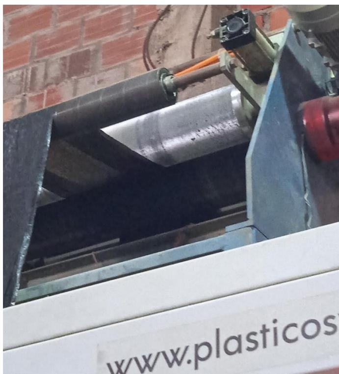
**Figura 45.** Rodillo jalador con silicona
