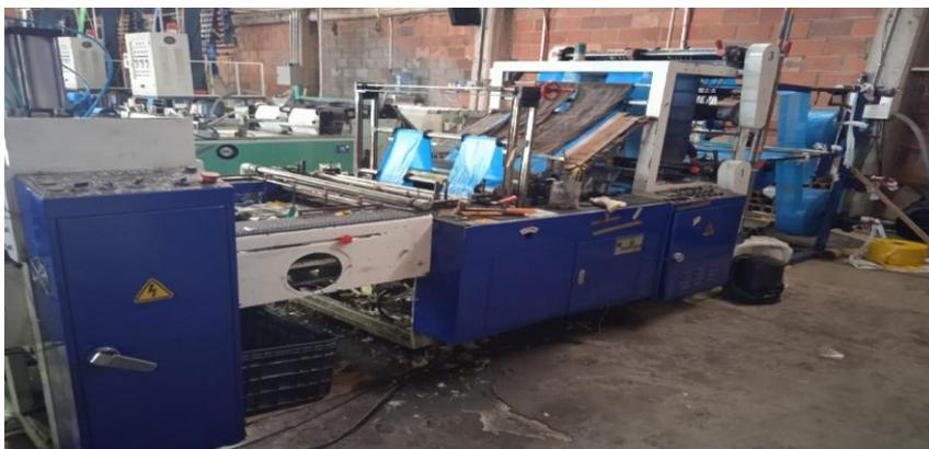
**Figura 14.** Selladora de corte frío
