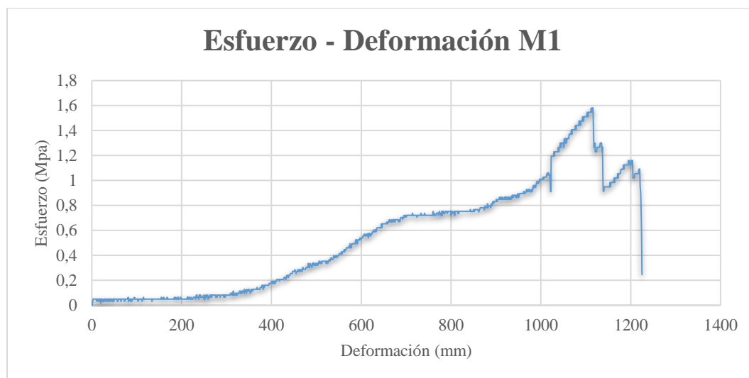
Figura 22 Esfuerzo vs Deformación del ensayo de tracción de la probeta del tejido obtenido a partir de la fibra sin aglutinante (M1)
