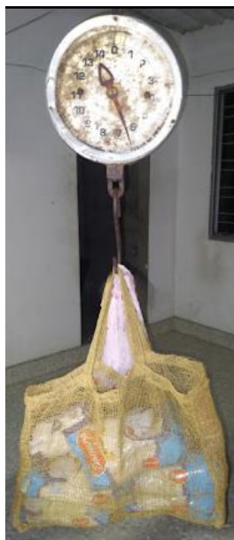
Figura 28 Capacidad soportada por la bolsa reutilizable a partir de la fibra del foliolo de la HPAA
