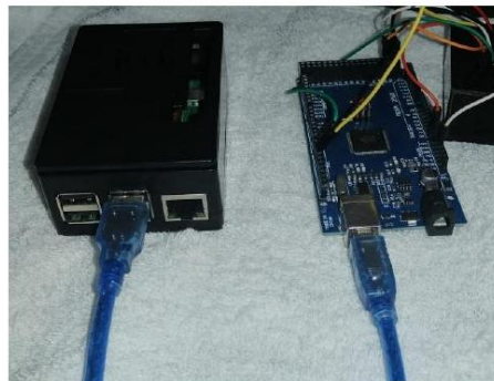
Fig15. Conexión R PI a la placa basada en Atmega2560.
