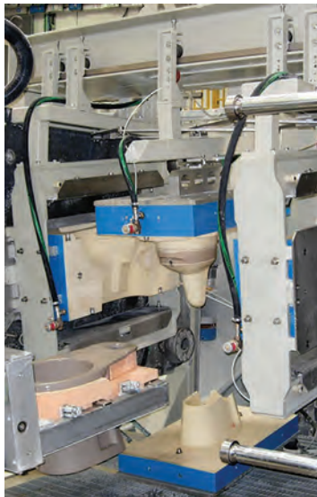
Figura 25. Desmoldeo inodoro al suelo
