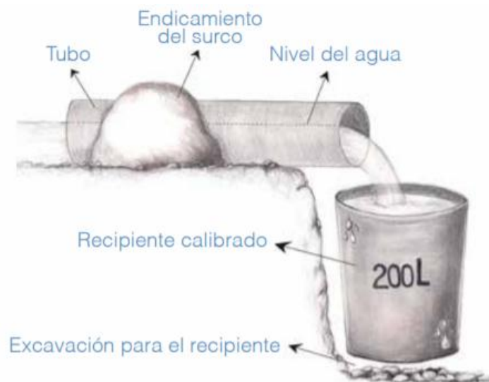
Figura 26. Método volumétrico para medición de caudales
