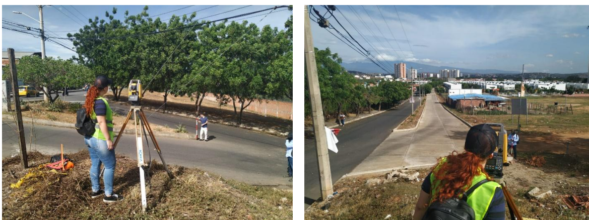
Figura 41. Ubicación y toma de datos con estación total.
